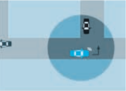
2. Nach wenigen Metern ist die befahrene Straße identifiziert. Abbiegen wird vom Gyroskop registriert.
