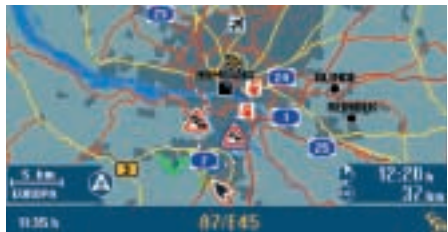
Navigationssysteme von Blaupunkt beziehen Staus automatisch in die Routenberechnung mit ein.
