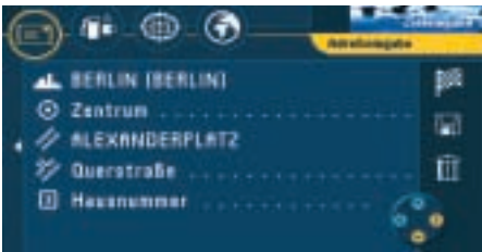
Der Bedienassistent unterstützt Sie durch eine farbige Kennzeichnung der Eingabemöglichkeiten.
