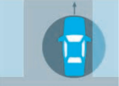
3. Jetzt ist die Position punktgenau bestimmt und wird durch einen ständigen Abgleich aller Sensordaten mit der digitalen Karte auf dem aktuellen Stand gehalten.
