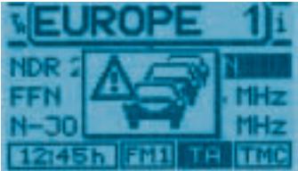
TMC und TIM® ermöglichen dem TravelPilot DX-R70 eine vorausschauende, dynamische Navigation. TMC lässt Staus rechtzeitig erkennen und in der Routenberechnung berücksichtigen. TIM® speichert alle Verkehrsmeldungen, auch wenn das Gerät nicht angeschaltet ist.
