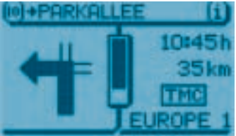
Akustische und optische Fahrrempfehlungen weisen Ihnen den Weg. Die Entfernungsanzeige im Display informiert Sie über die Entfernung bis zum Fahrmanöver.
