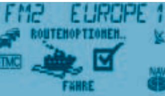
Selbstverständlich stehen Ihnen diverse Routenoptionen zur Verfügung. So können Sie beispielsweise wählen, ob das System eine Route mit oder ohne Fahrfahrten berechnen soll.
