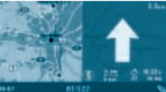
Der Mixmode ermöglicht eine gleichzeitige Pfeil- und Kartendarstellung. Sie können sich aber auch für jeweils eine Darstellung entscheiden.
